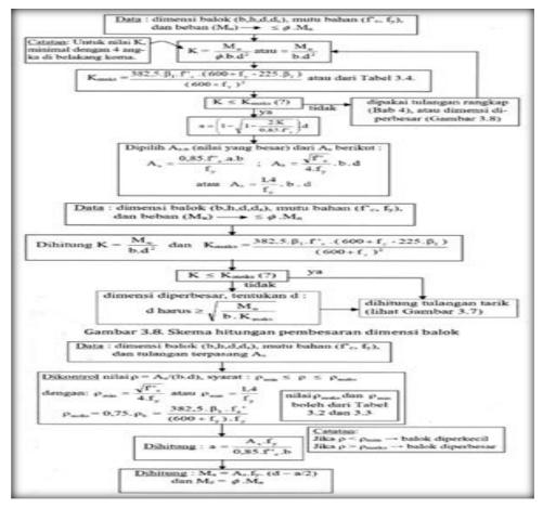
Gambar 1. Skema perhitungan tulangan longitudinal balok tulangan tunggal
