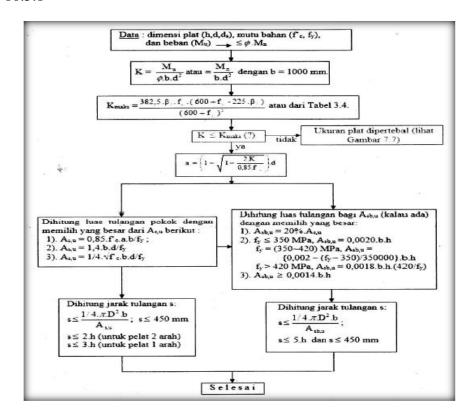
Gambar 3. Skema perhitungan pelat
