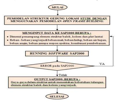
Gambar 4. Flowchart perhitungan portal gedung lokasi studi dengan menggunakan SAP 2000
