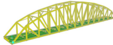
5 Gambar 1. Jembatan Tipe Parker Truss 3D
