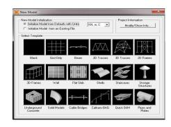
**Gambar 3.2** Menentukan bentuk struktur pada program SAP 2000
