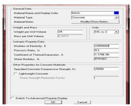
**Gambar 4.6** Pengesetan untuk bahan material
