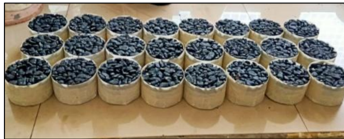
Gambar 8. Benda Uji Marshall CPHMA Sebelum Diberi Pasta Semen
