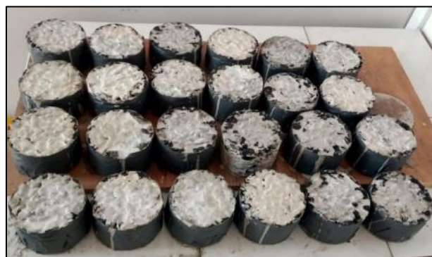
Gambar 9. Benda Uji Marshall CPHMA Setelah Diberi Pasta Semen
