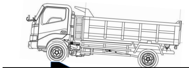
Gambar 2. Beban yang dijadikan pemicu timbulnya getaran pada jembatan
