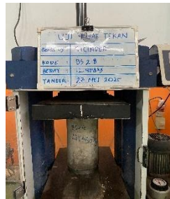
Gambar 8. Uji Kuat Tekan Silinder
